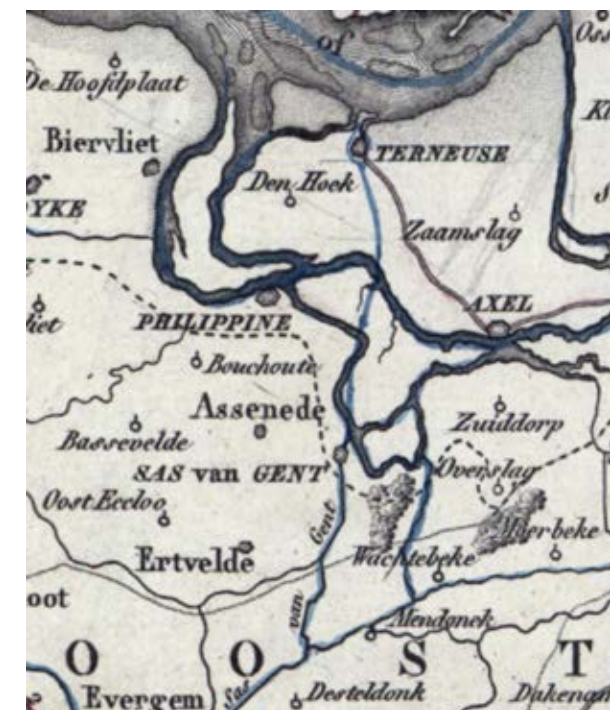
Afbeelding 5.12 (boven): bij de aanleg van het kanaal moesten twee brede kreken, die nog in verbinding stonden met de open zee, overbrugd worden. Daarbij werd ter hoogte van het Sassche Gat een bocht aangebracht, zodat het breedste punt van de zeearm vermeden kon worden.
